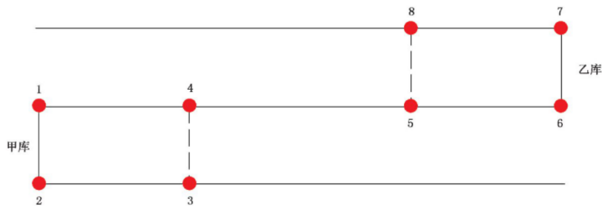
图 B.3 牵引车桩考项目模型测绘点示意图
